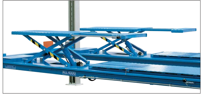
Tavola ausiliaria elettroidraulica di sollevamento libera ruote con prolunga incorporata. Capacità 3 Ton. (Art. 401/I - 401/CSAI - 403/LSI - 403/CSAI)
