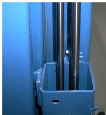
Двойные цилиндры в каждой колонне защищены кожухом
