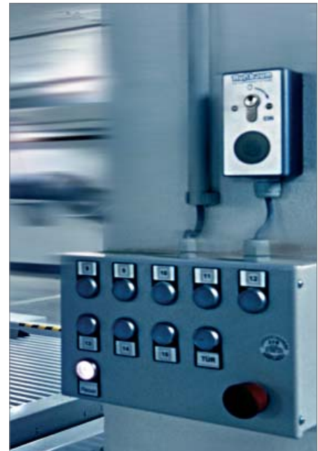
Abb. oben: Bedienelement mit Not-Aus (freiprogrammierbare Ausführung)
